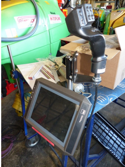
Abb. 14: Das Gerät ist mit einem ISO-Bus Terminal (Touch 800) ausgestattet.
