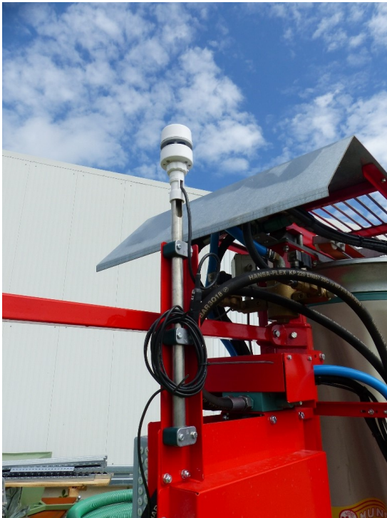
Abb. 8: Sensor für die Luftmengensteuerung „Varimas“. Die Teilbreitenventile sind unter einer Abdeckung am Gebläsetragrahmen angeordnet.
