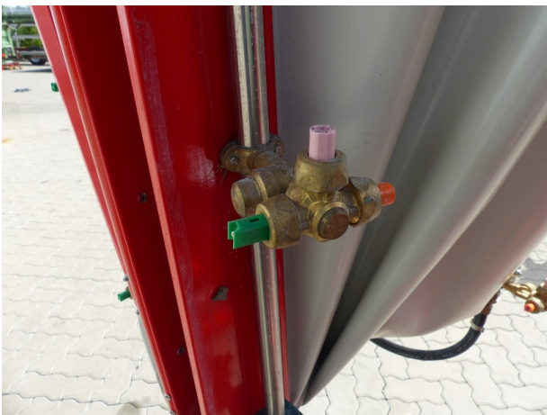
Abb. 13: Die Dreifachdüsenkörper sind in Fahrtrichtung vor dem Gebläseauslass angeordnet.
