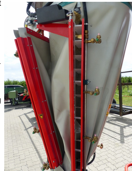
Abb. 7: Die Luftauslässe lassen sich beidseitig automatisch über das „Varimas“ oder von Hand schließen.
