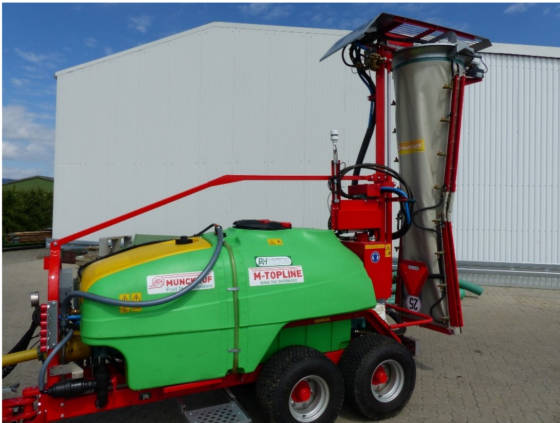
Anhängesprühgerät Munckhof Typ 107 mit variabler Luftumlenkung „Varimas“
