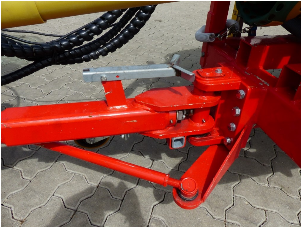
Abb. 2: Knickdeichsel (mechanisch) mit Anhängung über die Ackerschiene. Oben auf der Deichsel ist die Ablagevorrichtung für die Gelenkwelle zu sehen.
