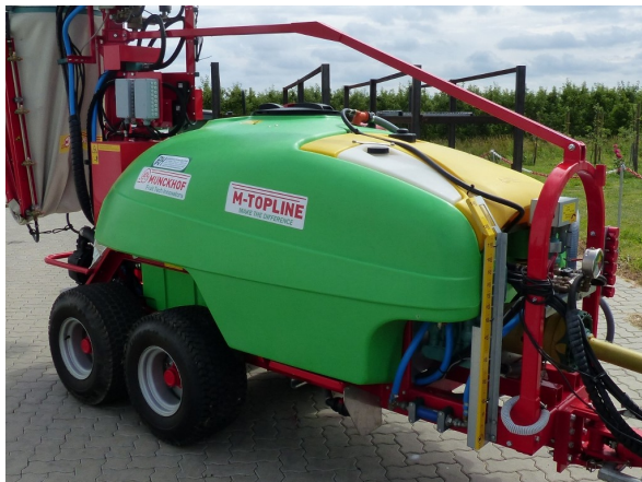
Abb. 3: Die vordere Volumenmarkierung reicht von 50 bis 1300 l und kann vom Fahrersitz aus gut eingesehen werden.
